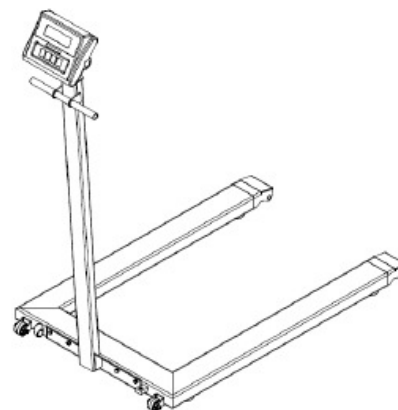
Anzeigenständer an der Rückseite fest montiert, zum Transport – einfach kippen und verfahren
